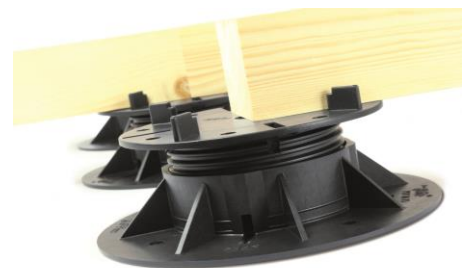
Abb. 8: Höhenverstellbares Grundelement PLV50/75, hier als Unterkonstruktion für die tragende Konstruktion einer Holzterrasse.
