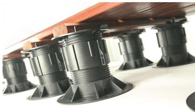
Abb. 10: PLV50/75 Grundelement mit einem ZSt65/100, Stelzenhöhe von 135-170 mm verstellbar. Holzbelag.
