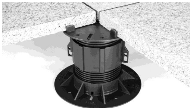
Abb. 9: PLV50/75 Grundelement mit einem ZSt65/100, Stelzenhöhe von 135-170 mm verstellbar. Plattenbelag
