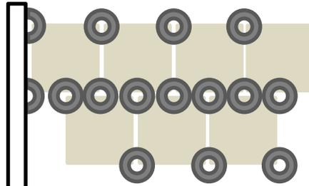
**Plattenformate mit versetzter Fuge:**
