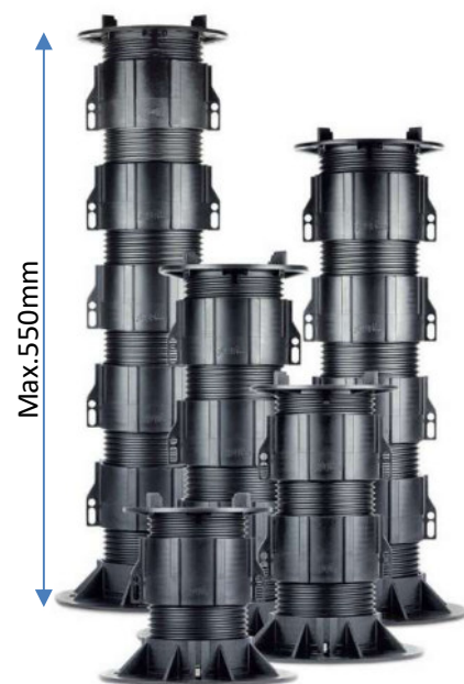
Abb. 14: Höhenverstellbares Terrassenlager PLV50/75 mit 1-5 Zwischenstücken ZSt65/100, Höhenausgleich von 135-550 mm.
