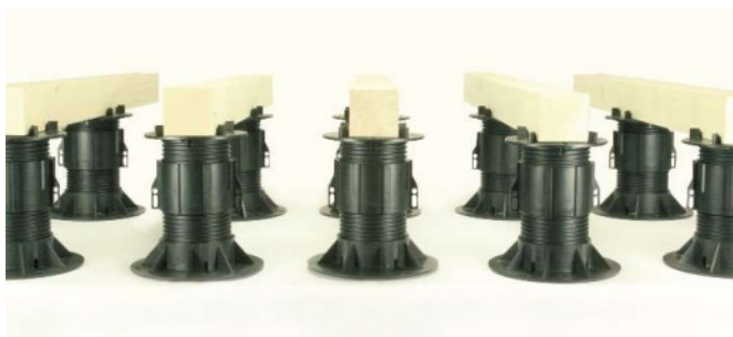
Abb. 26: Aufbau einer Kantholzkonstruktion, 135-170 mm Höhenausgleich durch PLV50/75 mit ZSt65/100. Der Belag wird auf die Kanthölzer gelegt und verschraubt.
