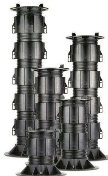
Abb. 14: Höhenverstellbares Terrassenlager PLV50/75 mit 1-5 Zwischenstücken ZSt65/100, Höhenausgleich von 135-550 mm.
